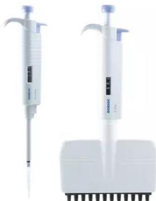
Все дозаторы прошли проверку качества в соответствии с ISO8655-2: 2002 с сертификатом калибровки. Контроль качества включает гравиметрическое тестирование каждой пипетки с дистиллированной водой при температуре 22 °С.
