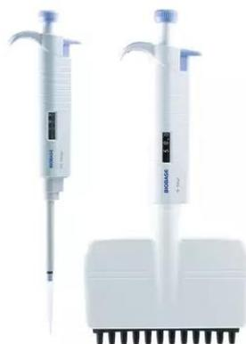
Все дозаторы прошли проверку качества в соответствии с ISO8655-2: 2002 с сертификатом калибровки. Контроль качества включает гравиметрическое тестирование каждой пипетки с дистиллированной водой при температуре 22 °С.
