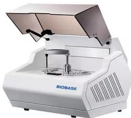
Автоматический анализатор свертывания крови используется для быстрого определения свертывания крови. Подходит для клинических испытаний в больницах, лабораториях и научно-исследовательских институтах. Прибор проверяет функцию коагуляции оптическим методом. Пункты тестирования включают протромбиновое время, РТ; активированное частичное тромбoplastиновое время, АЧТВ; тромбиновое время, ТТ; фибриноген, FIB; При калибровке прибора результаты могут отображаться в различных единицах измерения.
