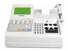
Этот анализатор коагуляции представляет собой одноканальный прибор. Принцип измерения - оптическая колориметрия. После смешивания реагентов с плазмой фибриноген превращается в фибрин и коагулирует, таким образом, оптическая плотность исследуемого образца изменяется, и анализатор может определить конечную точку коагуляции.
