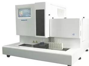
Анализатор мочи - это автоматизированный прибор для определения определенных химических компонентов в моче. Это важный инструмент для автоматизированного исследования мочи в медицинских лабораториях. Он имеет преимущества простой и быстрой работы.
