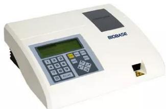
Анализатор мочи - это прибор, объединяющий в себе современную оптику, электронику, компьютеры и другие передовые технологии. В оптической части используется усовершенствованный источник холодного света высокой яркости, чтобы уменьшить воздействие на окружающую среду при испытаниях и улучшить разрешение системы. Он известен простотой эксплуатации и точными результатами испытаний.
