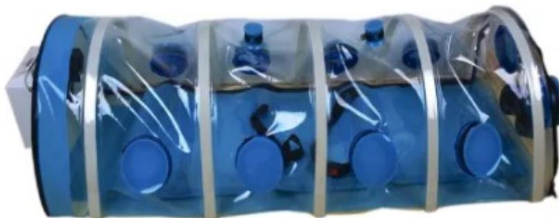
Изолирующая камера оснащена собственной системой фильтрации отрицательного давления, чтобы обеспечить максимальную защиту и безопасность работы как для загрязненного человека или элемента, так и для оперативной команды.
